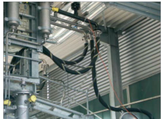
Kennzeichnung: Spiralmarkierung Gelb/Blau/Weiß & Prägebandstempelung FXD 25 · FLUORFLEX 2 · PTFE · FDA · 150° C · TRbF 131 · Ω · PN 16 BAR · ELAFLEX © 03.08
